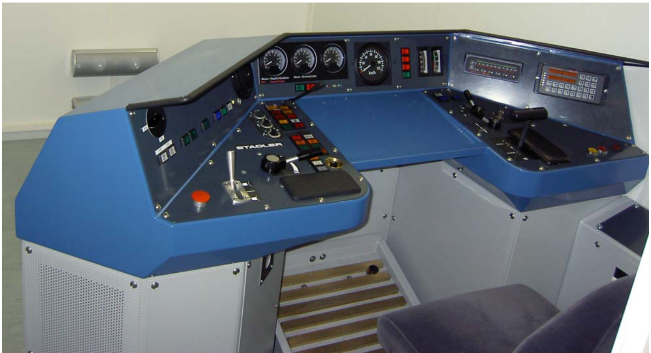
Führerpult Basis Matterhorn-Gotthardbahn-Niederflurtriebzug
