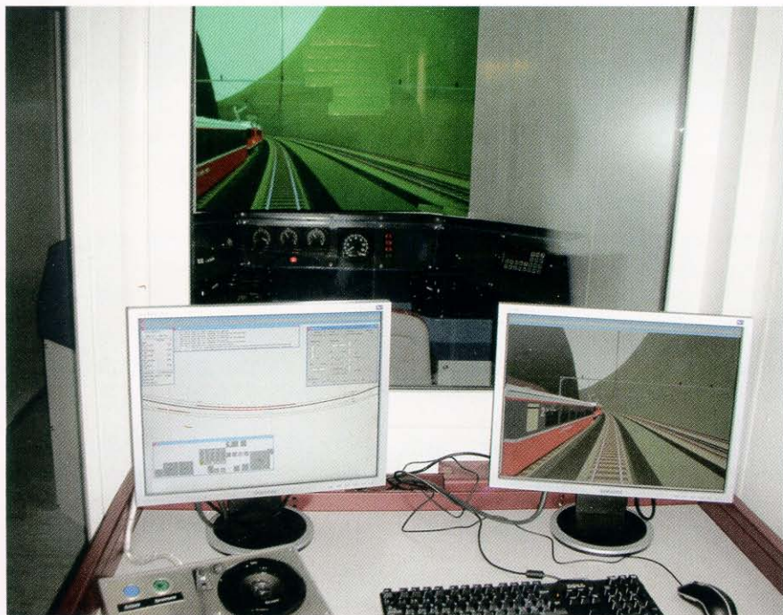
Im Vordergrund der Instruktorenplatz; im Hintergrund, hinter der Glasscheibe, das Führerpult mit Projektion des Führerstandausblicks.
