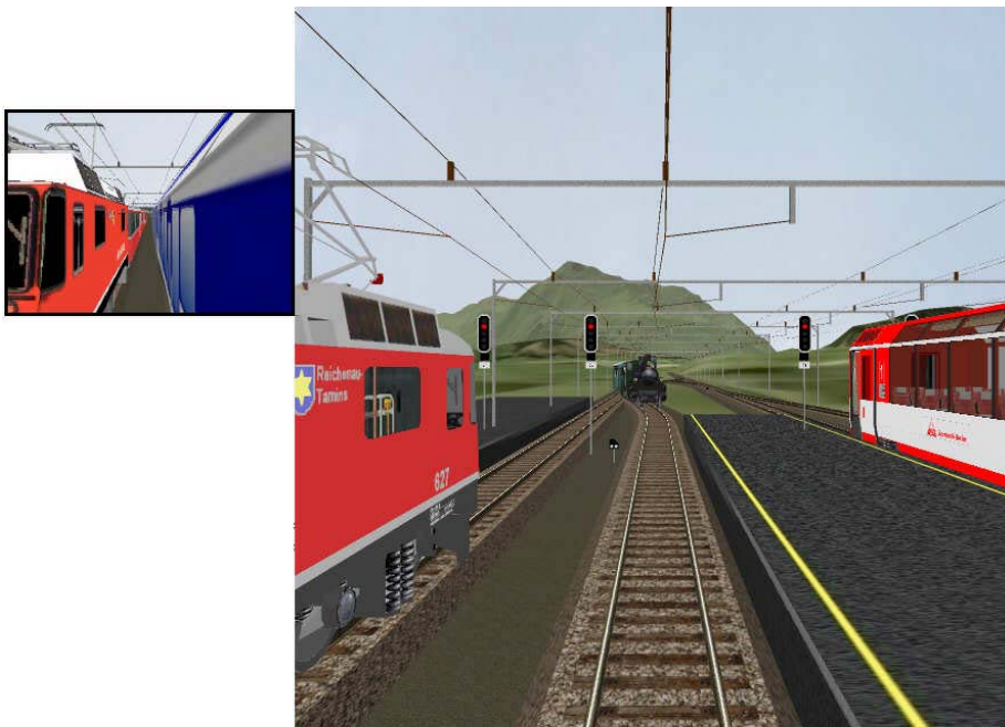
Vue depuis la cabine de conduite avec rétroviseur et plan de voie, représentant une situation du programme de formation du RhB avec un paysage virtuel tridimensionnel: plan de voie de Klosters avec comme décor de fond, le Rigi. Les signaux peuvent être modifiés par clic avec la souris dans le plan de voie; les trois autres trains peuvent être déplacés selon un scénario ou aussi manuellement (photo : BFH)
