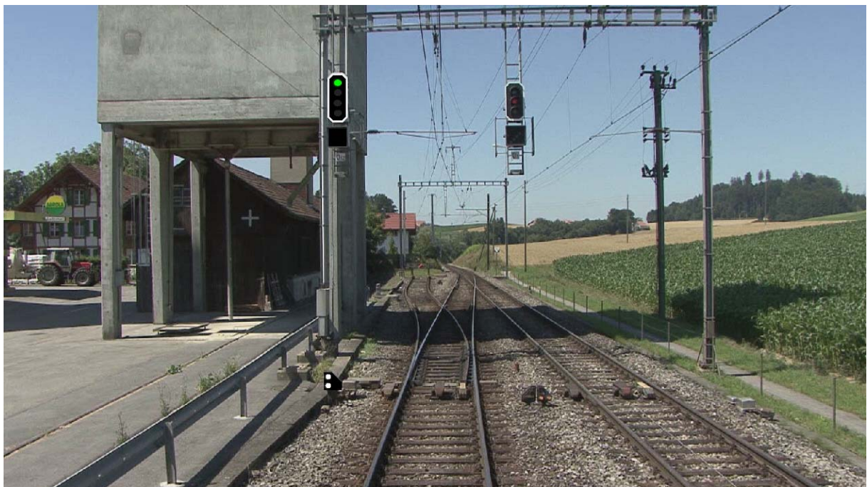
Au lieu de l'image virtuelle tridimensionnelle il est possible d'utiliser des enregistrements vidéo: Rosshäusern (ligne Berne – Neuchâtel) avec signaux de sortie, de départ et signaux nains dont l'image peut être variée. (Photo : BFH)
