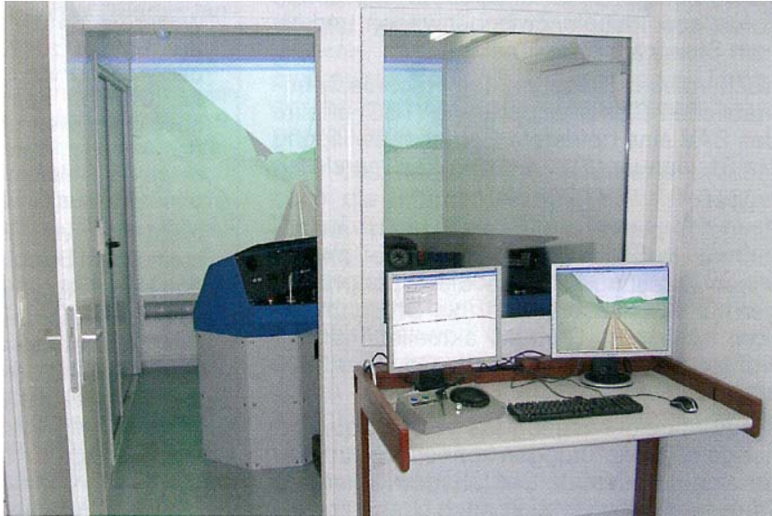
Vue de l'intérieur du conteneur de simulation. Vue depuis la salle de discussions avec emplacement de l'instructeur à travers la cloison de séparation en verre vers le pupitre de commande et la projection de la vue depuis le poste de conduite. Sur l'écran droit de l'instructeur est également visible la vue depuis le poste de conduite, sur celui de gauche, la surface de commande du programme de simulation avec le plan des voies (Photo: D.Fankhauser)
