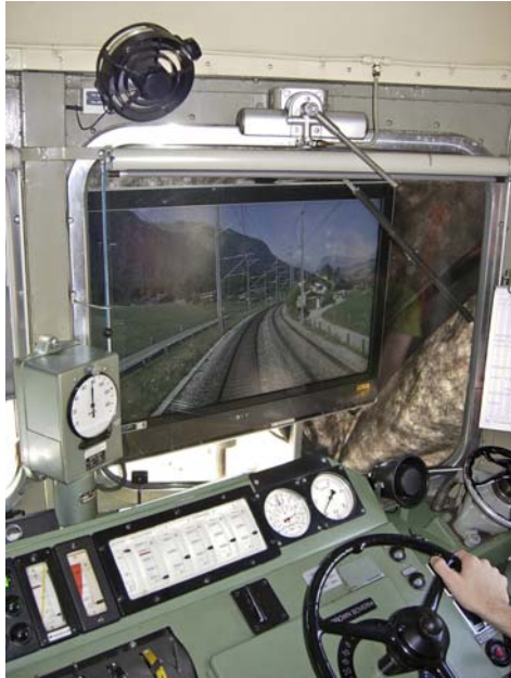
L'Ae 4/4 251 en mode de fonctionnement de simulation: à pleine vitesse près de Frutigen, observez les ampèremètres et le tachymètre (photo: J.Bolliger)
