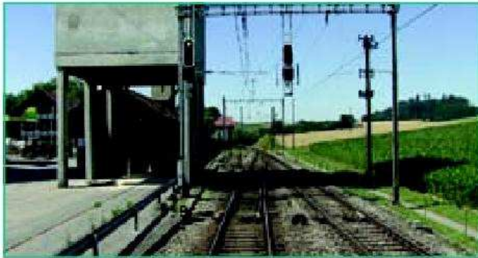
Videodarstellung der Strecke. Die drei (in der Schweiz links vom befahrenen Gleis befindlichen) Signale sind durch Bitmaps überschrieben und können vom Instruktor oder von einem Szenario beliebig verändert werden, mit entsprechender Auswirkung auf die Zugsicherungsmagnete, -balisen und -loops. Printscreen von Führerstandsansicht während Simulation
