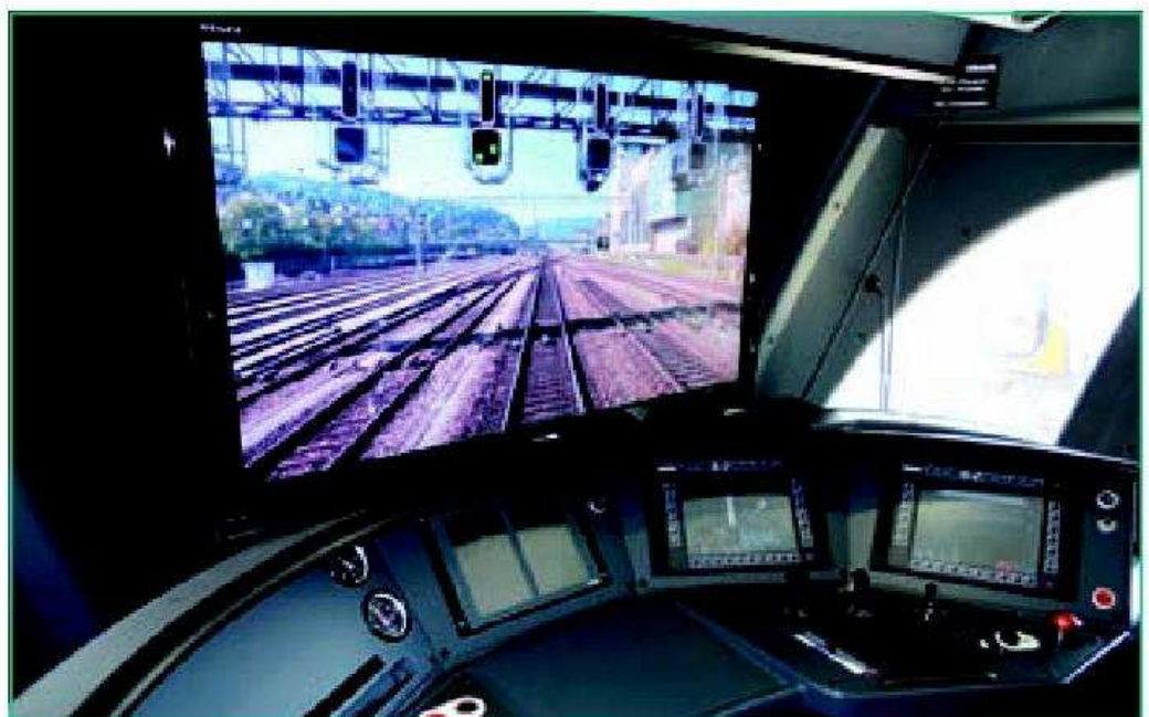
Eingerichteter Simulator auf einem Doppelstockzug KISS von Stadler Rail mit Monitor für Führerstandsansicht am Stirnfenster
